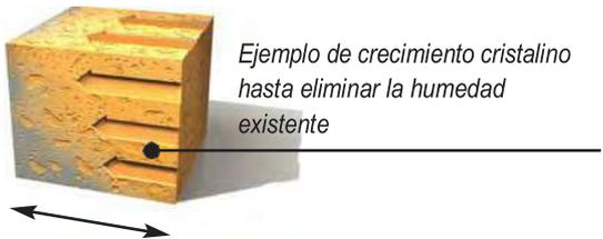
Ejemplo de crecimiento cristalino hasta eliminar la humedad existente
